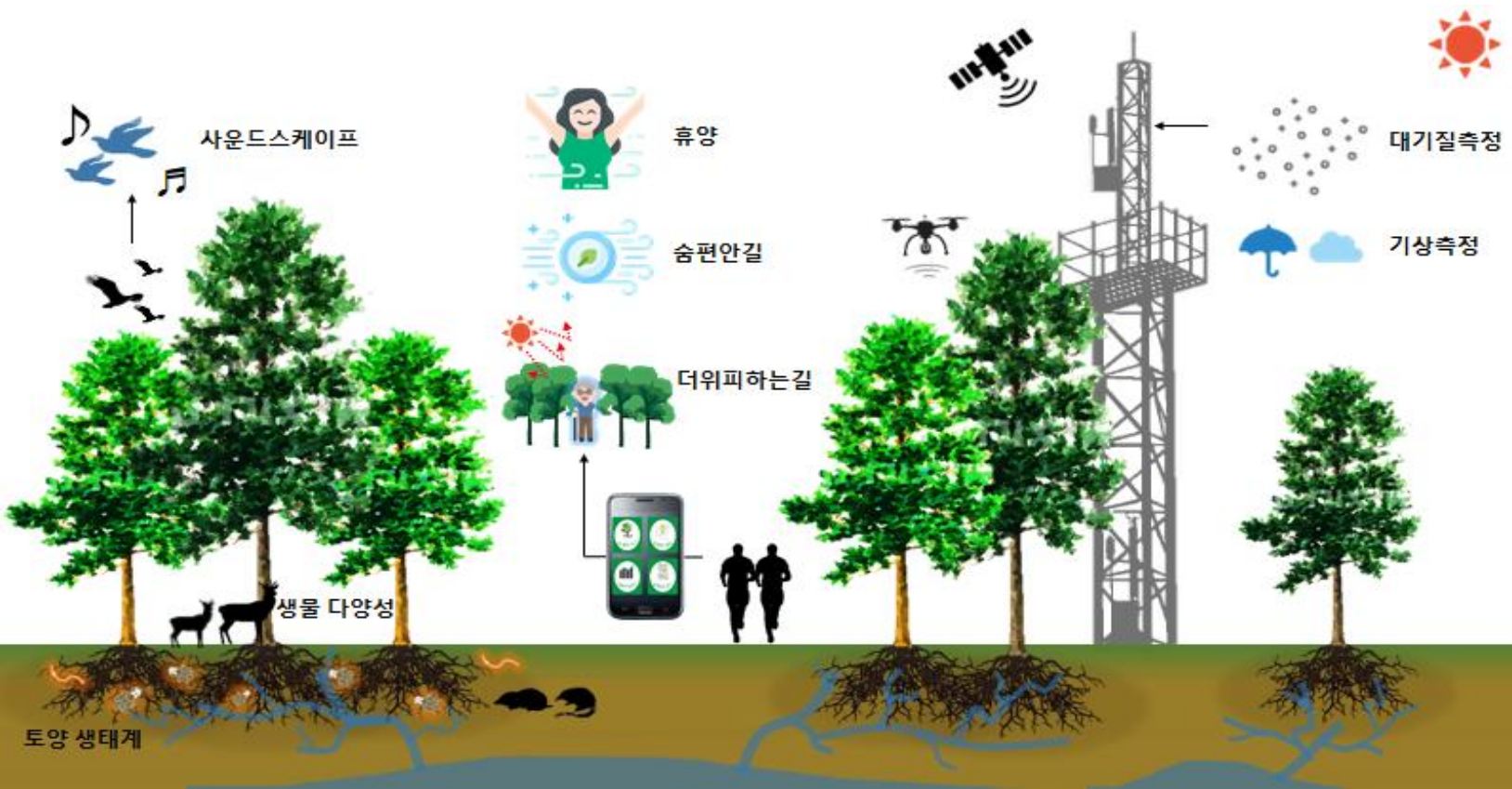
산림 미세먼지 측정넷 기반 '스마트 도시숲 모니터링넷' 모식도
